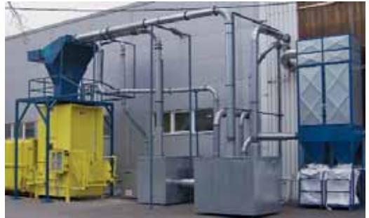
Kiseb kötéstet papírhulladék-elszívó rendszere
