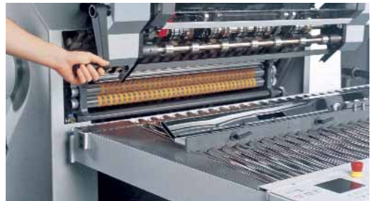
Stahlfolder hajtogatógépén a tengelyek felemelése (Heidelberg)
