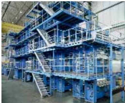
KBA Flexo-Courier: a világ legnagyobb flexórendszerű újságynyomó gépe (Photo: KBA)
