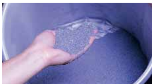
Gyricon mikrokapszulás elektronikus festék, felrétegzés előtt (Xerox-Gyricon)
