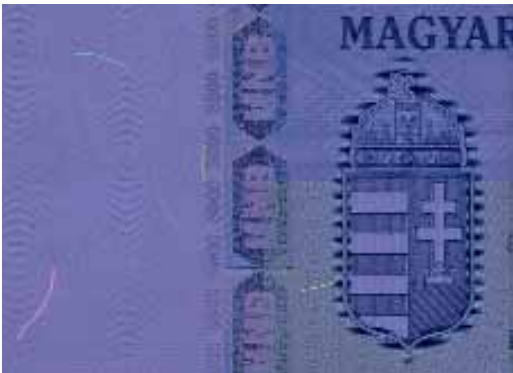
UV jelzőrostok képe az optikai fehérítőtmentes bankjegypapíron
