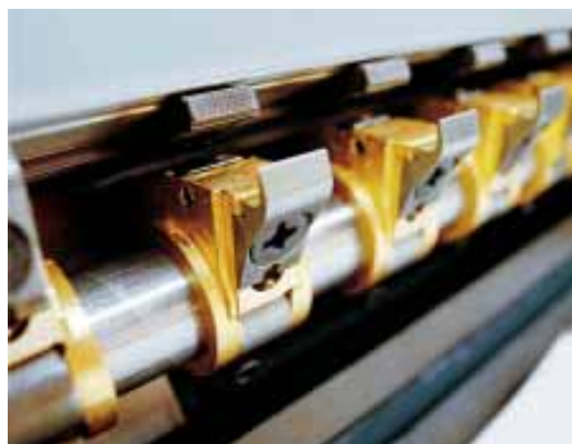
Az ívfogó ujjak és az ívfogó sor az íves ofszetnyomó gépek tipikus alkatrészei
