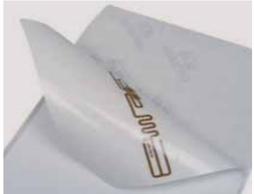
Nyomtatott antenna az RFID-címkében
