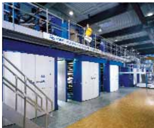
Kompakt és áttekinthető módon áll a CORTINA szárazofszet nyomógép a „Freiburger Druck” nevű nyomda legújabb rotációs csarnokában
