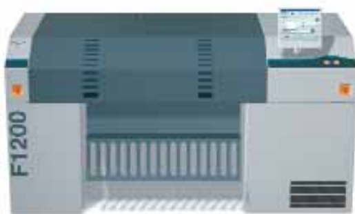
6. ábra. A Hell Gravure Systems GmbH cég HelioFlex F1200 típusú CTP lemezlevilágítója
