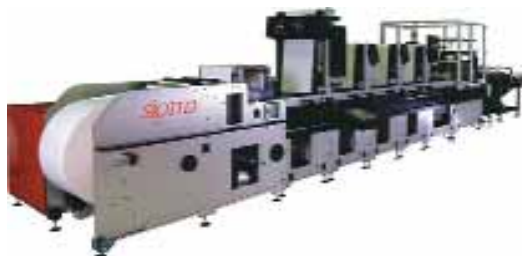
5. ábra. Az Edale LTD Sigma 510 márkájú, flexó- rendszerű csomagolóanyag-nyomtató gépe
