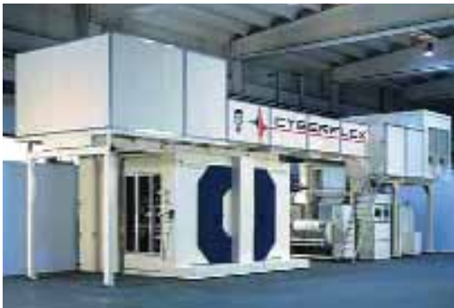
4. ábra. A Carin-Cargraf Srl cég Cyberflex márkájú, központi ellennyomóhengeres, fogaskerék-meghajtás nélküli flexó nyomógépe
