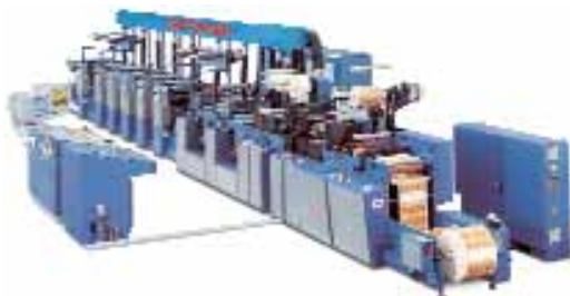
7. ábra. A Rotatek SA cég új, kombinált, Combi márkájú csomagolóanyag-nyomtató gépe
