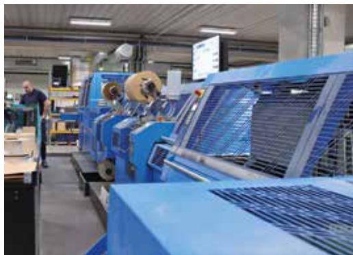
A Müller Martini Diamant MC 60 automatizálási csomaggal van felszerelve, amely gyors és hatékony átállásokat biztosít
