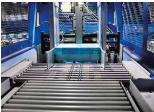
Az integrált BLSD könyvkiosztó egység kíméletes rakást és puffertelést biztosít
