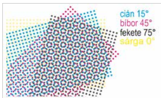
2. ábra. Jellegzetes rácselforgatási szögek
