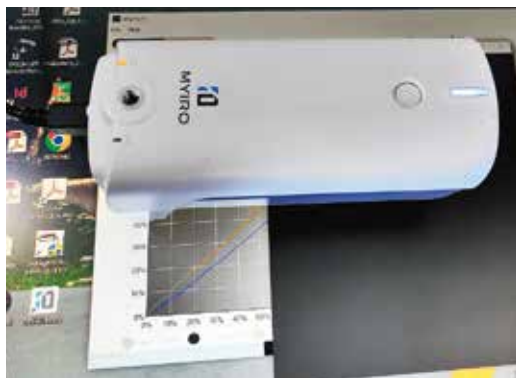
2. ábra. MYIRO 1 monitor kalibrációja közben
