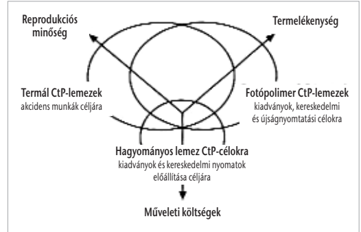
4. ábra. A különféle előérzékenyített CTP ofszetlemeztípusokkal szembeni felhasználói elvárások, a lemeztípusok műszaki, gazdasági, használati jellemzői és az alkalmazási területek közötti összefüggések
