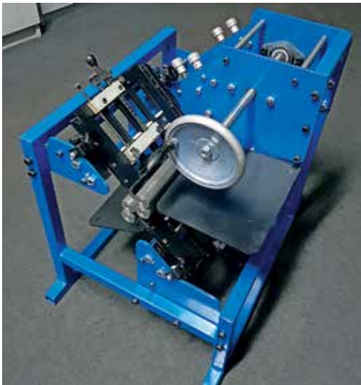
3. ábra. Az összeállított hajtogatógép modell kezelő oldala
