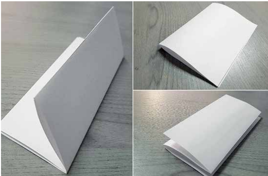
5. ábra. A hajtogatógép modellen megvalósított felezőhajtás, hatoldalas leporellóhajtás és nyolcoldalas haránthajtás
