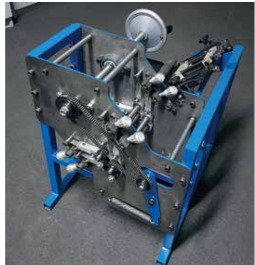
4. ábra. Az összeállított hajtogatógép modell hajtás oldala
