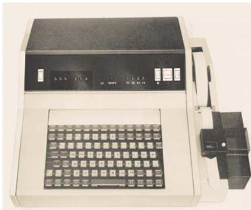
Monophoto 913, az első tömegesen használt lyukszalagos szövegrögzítő munkahely
