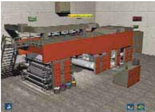
Központi ellennyomó-hengeres flexó nyomógép
