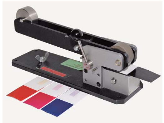
„Carboning” teszter, átnyomódás-vizsgálathoz
