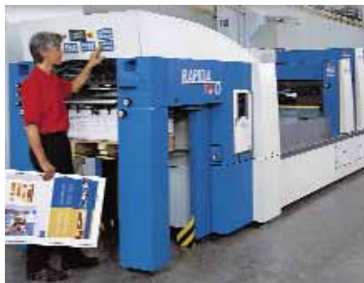
KBA Rapida 74 G TM világújdonság. Csúscsminőség, víz nélküli nyomtatás és a GraufLOW TM festékezőművek révén
