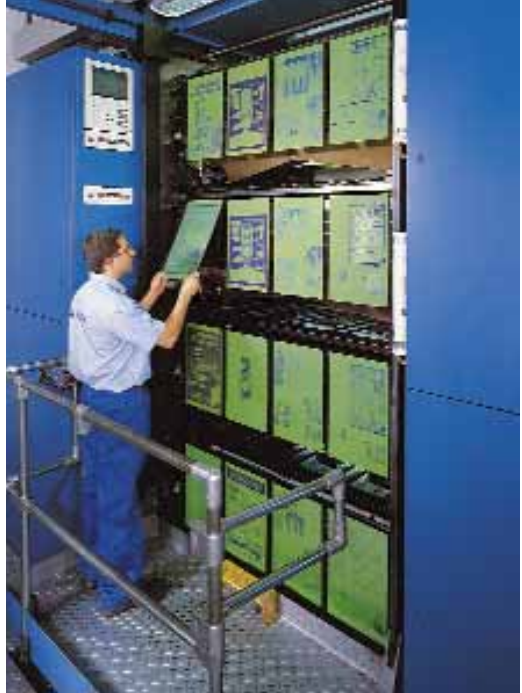
Víz nélküli újságy nyomtatás, zónacsavarok nélkül a KBA Cortina kompakt tekercsnyomó géppel. A vásárra készült „Cortina drupa Times”
