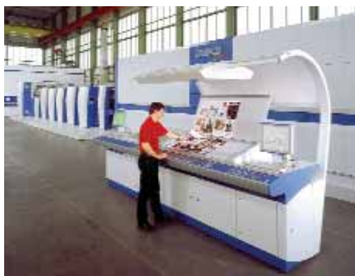
Compacta 217 tekercsnyomó gép. Tizenhat oldalas, max. 70 000/óra fordulatszámmal.
