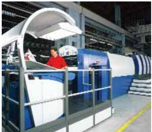
KBA Rapida 105 – az új közép kategória sok egyéni jellemzővel (18 000-ig terjedő óránkénti fordulatszám, tengely nélküli berakómű-meghajtással, oldalilleszték nélküli ívillesztés, majdnem valamennyi gépi funkció elő-, ill. távállítása az új Windows-vezérlőpultól stb.)
