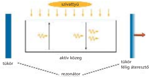
2. ábra. Egy lézer elvi felépítése
