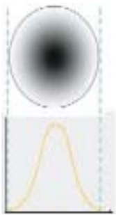
4. ábra. A fényerősség megoszlása a lézergusáron belül
