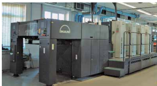
manroland R 704 3B (4/0) típusú, digitális vezérlésű ofszet nyomógép
